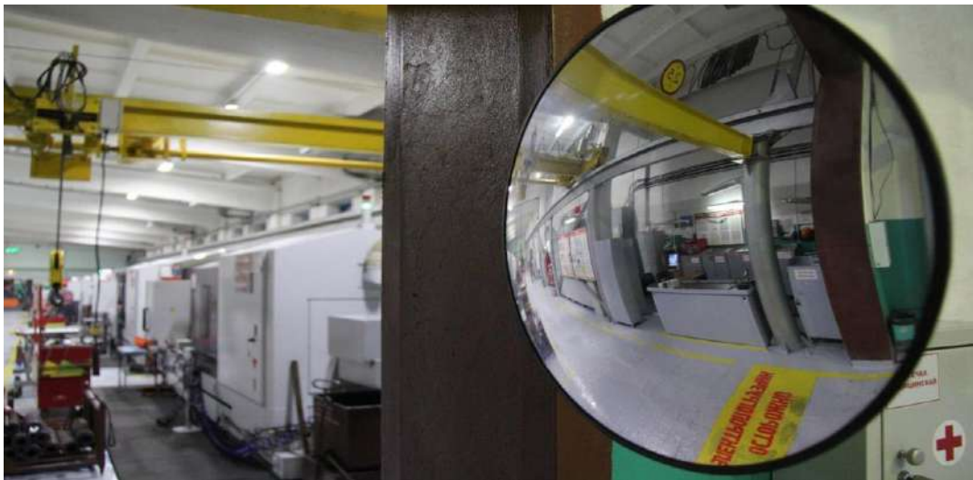
Рисунок 54 Внутри производственных помещений и на территории предприятия в зонах ограниченной видимости установлены зеркала
