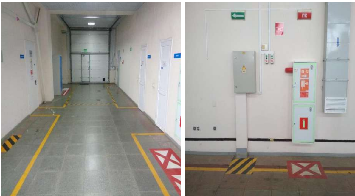
Рисунок 19 Визуализация опасных зон производственных помещений
